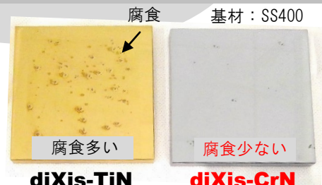
耐食性試験 (10%HCl, 96h)
