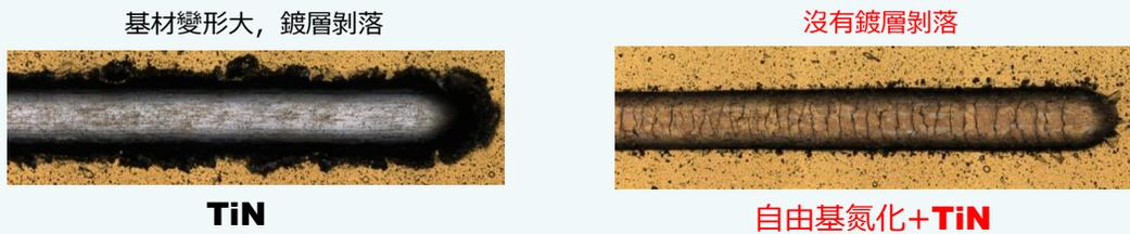
通過划痕試驗對TiN鍍膜的附著力進行比較（基材SKH51、100N負載下的壓痕）
