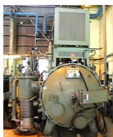
高速ガス冷却式横型真空熱処理炉
