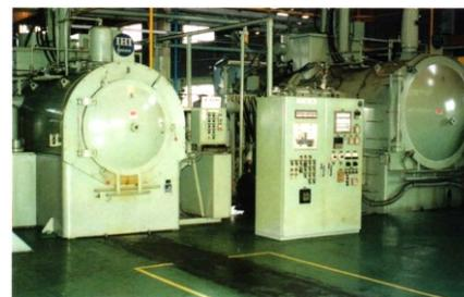
油槽付横型真空熱処理炉
